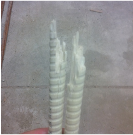
Figure A-44. RB-1: Bottom Bar #3 fracture plane.
