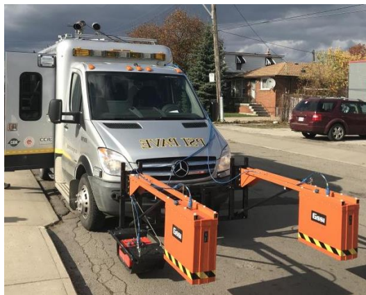
Figure 3-1: PSIPave Survey Van
