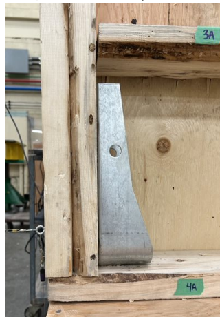
e) Left side hold down (near 4A)
