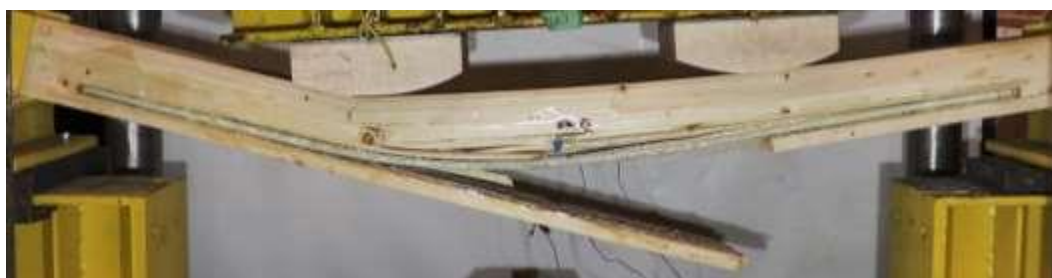
(d) Ultimate failure
