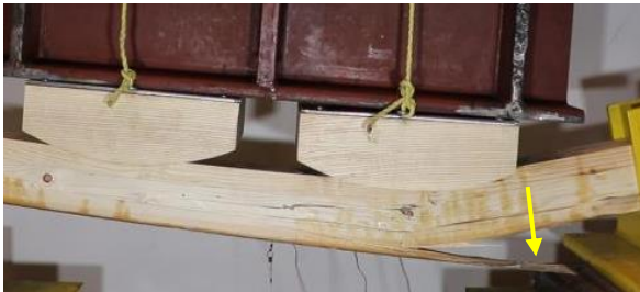
(d) Failure at FRP termination point in Vetter (2022)
