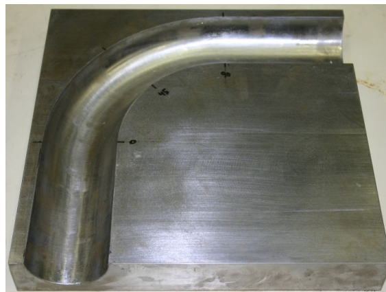
Figure 45: 90° bend template die
