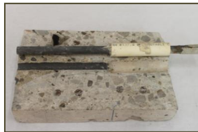
(d) Cut off slices showing the bond failure
